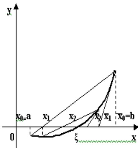
Рис. 4. Уточнение корня комбинированным методом
