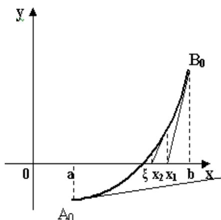
Рис. 3. Уточнение корня методом (касательных) Ньютона
